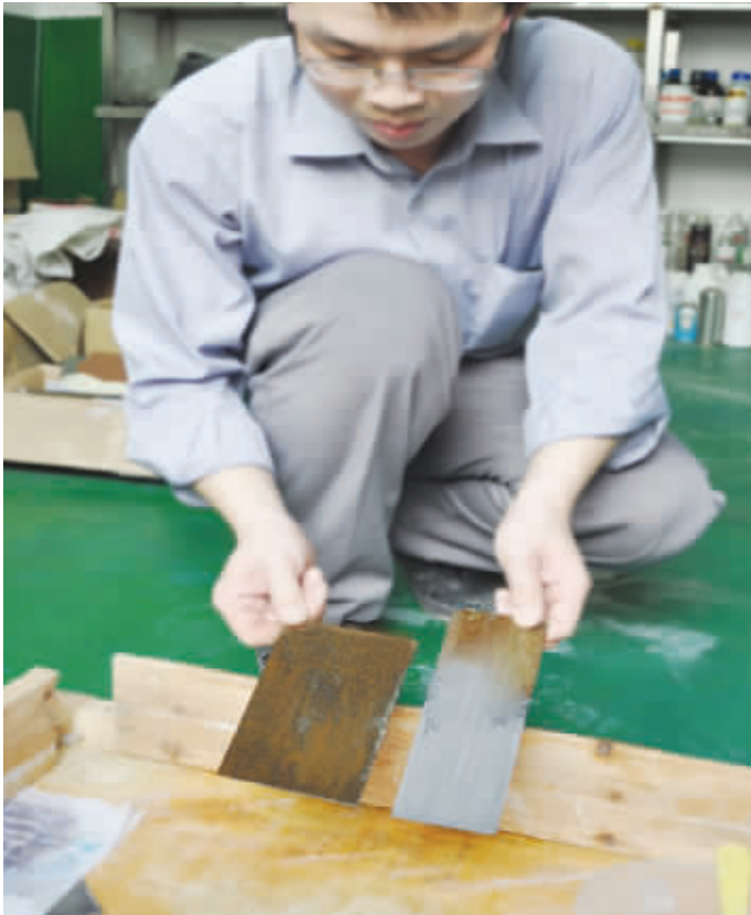
左为未涂防锈除锈处理药剂的锈铁片,右为涂了药剂的锈铁片。
