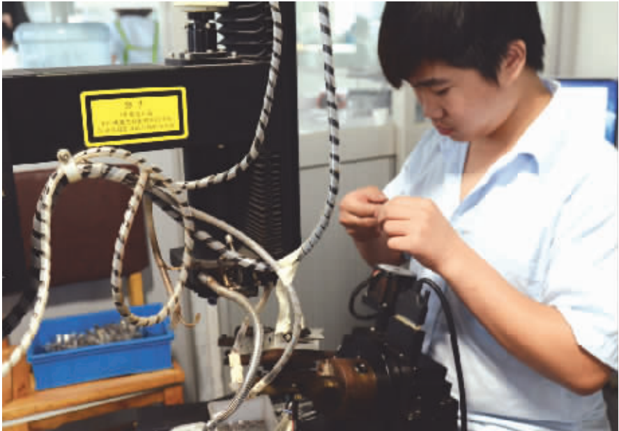
“方氏眼镜”员工使用激光点焊机加工眼镜框
