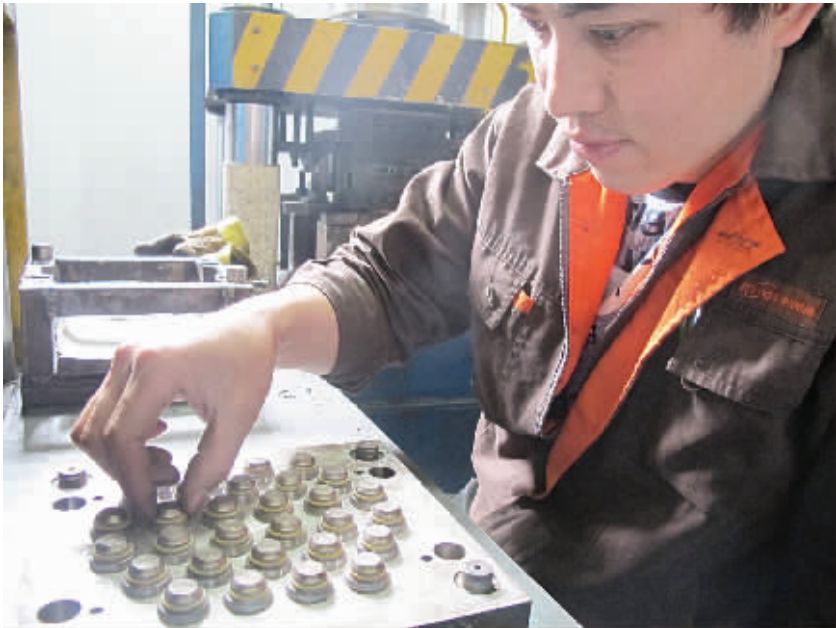
企业员工正在对燕尾式电机换向器进行加固
