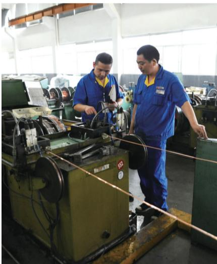
经过改造,原本只能拉一条铜皮的拉丝机现在可同时拉四条(如左图)。液压机的加热板外加一块小小的保温板,一年能节省15万度电。在原材料成本、劳动力成本不断提高的当下,位于瑞安经济开发区的浙江长城换向器有限公司加大技术改造,通过节能降耗提高利润,一年下来,节能降耗方面能省下近百万元。
