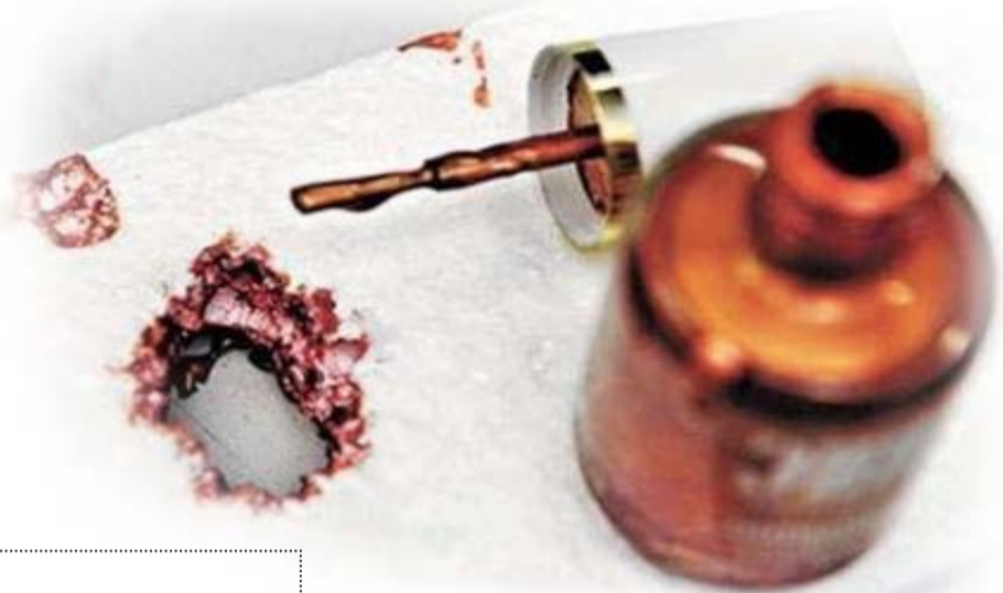
塑料泡沫板被腐蚀透
