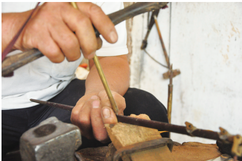
用钻在杆上钻出小洞,用来钉“星”
