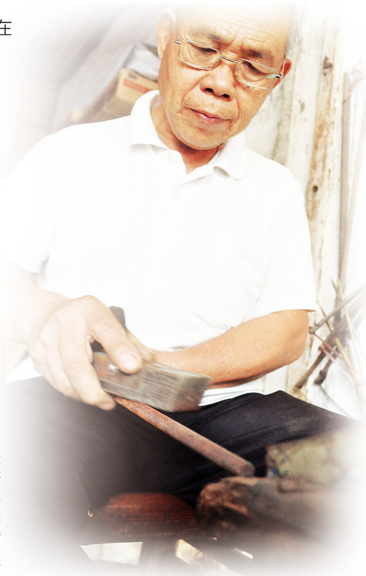
制作秤杆第一步,打磨木坯,要做得又滑又直
