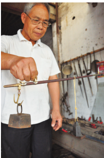
用砝码检测杆秤的精确度
