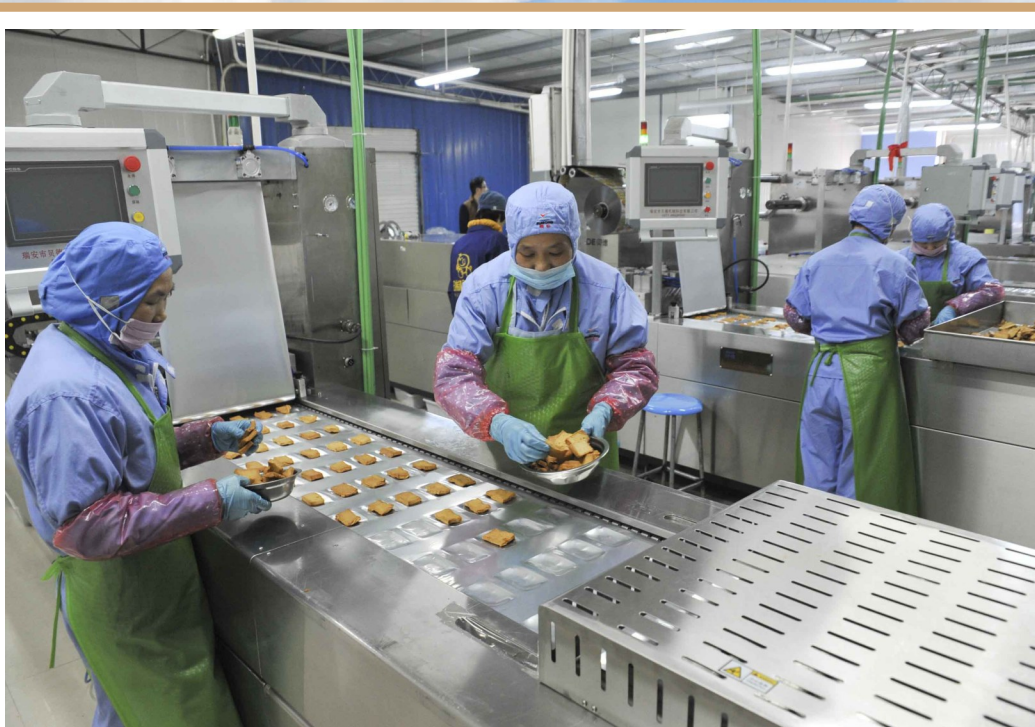
在瑞松公司，工人在自动真空包装机上包装休闲鱼豆腐。
