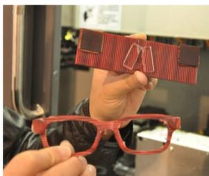
全自动眼镜数控加工机打磨出的眼镜架
