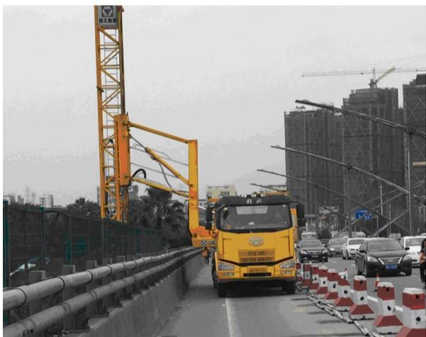
本报讯(记者 黄丽云 通讯员 林阳阳)日前,飞云江姐妹桥上来了辆桥梁检测车,施工人员在现场对桥梁的路面、梁板、支座和梁盖等进行了检测(如图)。据悉,今年我市共有93座国省道桥梁列入“健康体检”计划。
