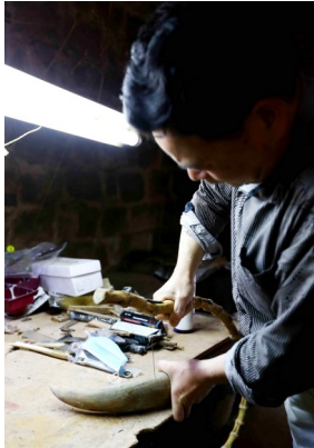
陈光宇在工作室里用传统的弓形手锯对牛角进行切割
