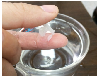
温水浸泡10分钟后，胶水被轻松剥离
