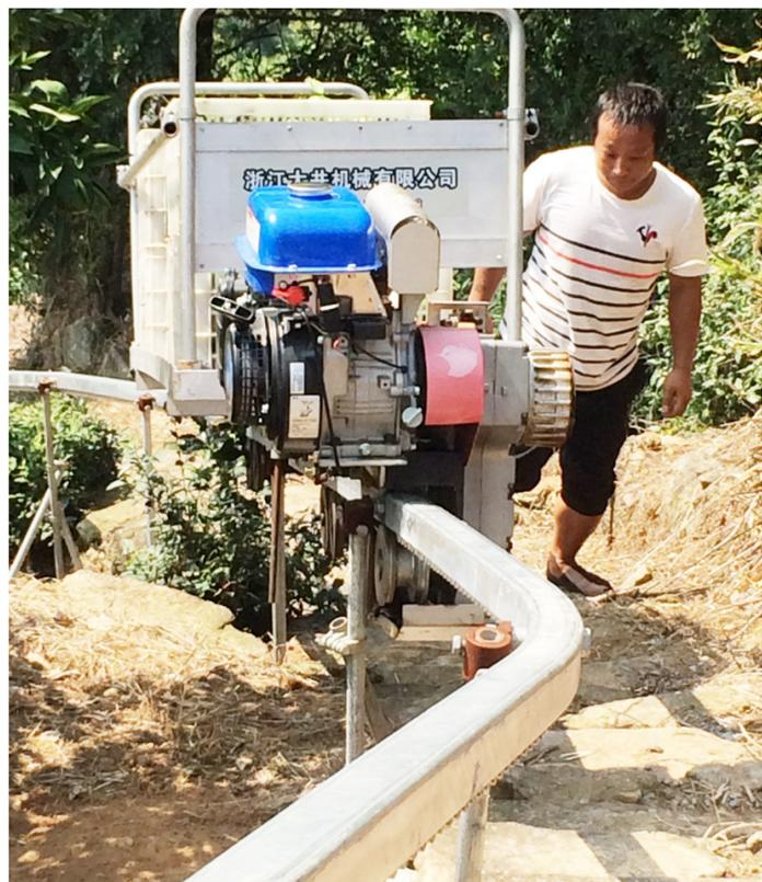
这种情况得到了很大的改善。果园的工作人员介绍,山地单轨运输机的最大载重量是200公斤,考虑到平稳运输的需要,走完300米的轨道大约需要半个多小时,一条轨道一天总共能运输大约5000公斤的果实。果园的工作人员只需对机器进行简单操作,就可轻松完成运输任务。
