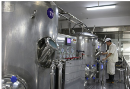
工人正在真空浓缩工段作业
