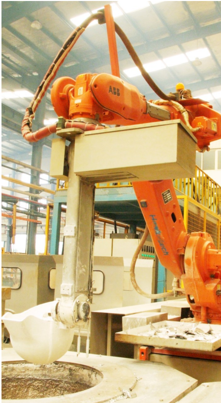
瑞明集团车间内的智能化浇注机器人
