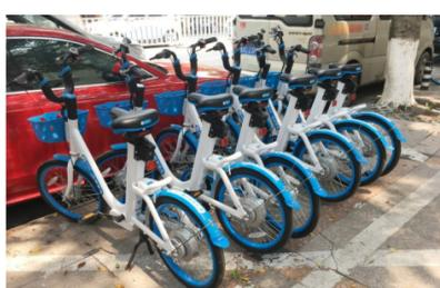
共享电单车更像是助力车,让用户在骑行时更省力,最高速度15公里/小时,在充满电的前提下可以骑行20多公里。据该负责人介绍,共享电单车的后台会实时监督车辆电量,发现电量过低时,工作人员会根据定位找到车辆,更换电池,保证在路上运营的车辆电量充足。
