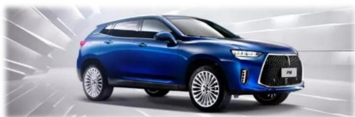
包采用1并12串电池模组,体积较大,放置在原来备胎的位置占用了后备厢空间。如果要装载大件物品,P8恐难胜任。P8全系标配智能四驱系统,搭载2.0T涡轮增压发动机+电动机,综合功率250kW,综合扭矩524Nm。2.0T发动机驱动前轮,电动机驱动后轮,工信部纯电续航50km,最大续航660km,综合工况百公里油耗2.3L,12.96kWh的三元锂电池组,最快充电时间4小时。
