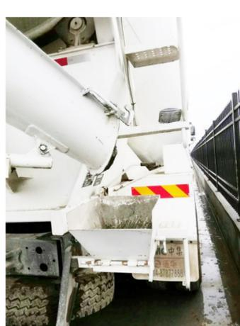
已安装好防漏设施的混凝土搅拌车
