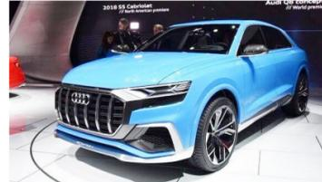
Q8搭载了2.0 TFSI和3.0 TFSI两款发动机,最大功率可达250kW,最大扭矩可达500Nm,配合Tiptronic八速手自一体变速箱与新的轻度混合动力技术(MHEV),为用户提供了智能、高效的驾驶体验,充分满足了日常都市出行的驾驶需求。
