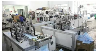
带后自动计数码堆;生产线采用“1+2”的构架,一台口罩成型机构通过传输系统,自动输送分流到两套耳带自动焊接加工工位;耳带通过超声波实现自动剪切、焊接,鼻夹也可实现自动送料剪切及超声波焊接……记者在现场看到,整个医用口罩生产过程一气呵成,成品生产速度每分钟达120只。
