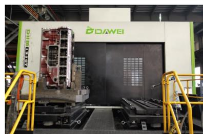
了多项创新设计,包括水道和油道的集成设计,减噪设计,刚度设计等。同时制定合适的工艺路线,设计和使用了多达55件(套)工装设备,定制专用刀具转接头,配套设计了“医用应急发动机直列六缸柴油机机体”专用干式自动检漏机,以配合机体的产业化生产。
