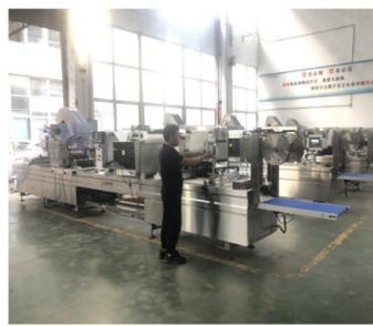
技术,一次性病毒采样管通过泡罩包装机加上了纸塑袋后,可阻隔外界的大分子气体、病毒等污染物进入其中,但环氧乙烷消毒气体可透过透析纸进入纸塑袋,对病毒采集管进行杀菌消毒。
