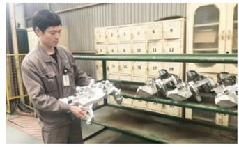
产过程稳定,且较传统油压系统节能约三分之二;生产线自动化高度集成,集自动下芯、浇注、取件、冷却、震砂、切割等为一体,按传统设置需26人,现集成后只需8人,大大节约了人工成本;采用一机双模技术,由传统单浇包升级为双浇包,由传统单模铸造升级为双模铸
