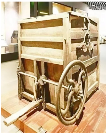
李毓蒙发明的铁木结构弹棉机
